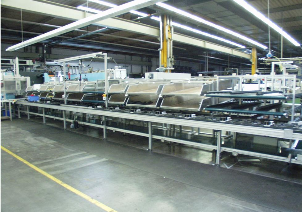
Kleinteilezuführung mit Vibrationsförderrinnen die von der Rückseite befüllt werden.
