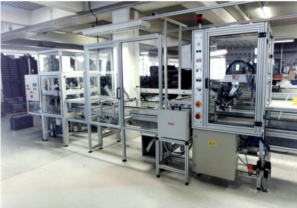
Vorgelegte Bauteile werden an verschiedenen Stationen verstemmt oder vernippelt.
